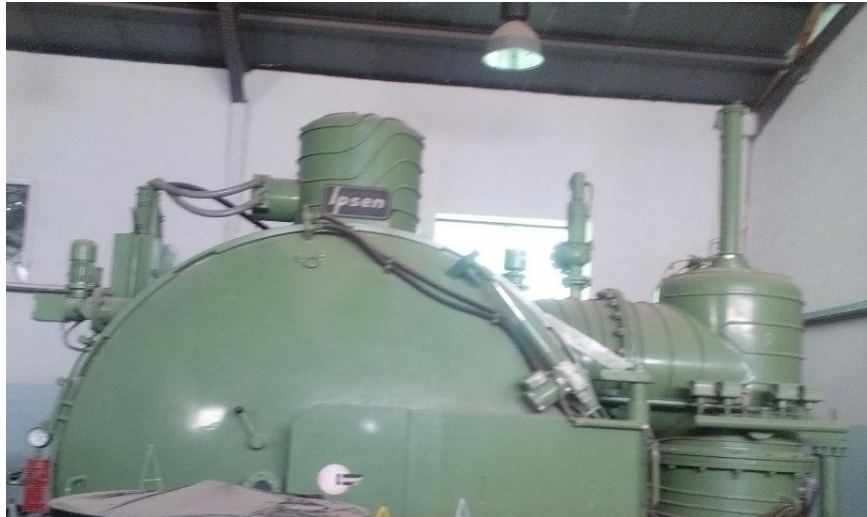
Fig.IV.1. Vue extérieure du four à gaz.
